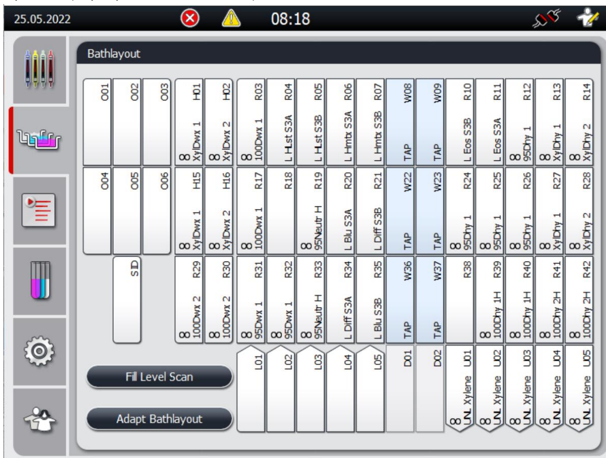
Рисунок 1. Пример схемы ванны двойной системы окрашивания гематоксилином и эозином
