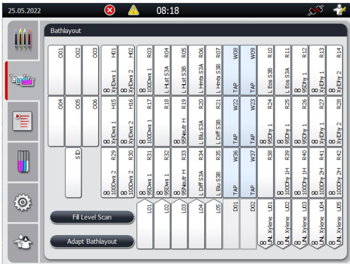
Immagine 1 - Esempio di configurazione del bagno per il Sistema di colorazione H&E doppio
