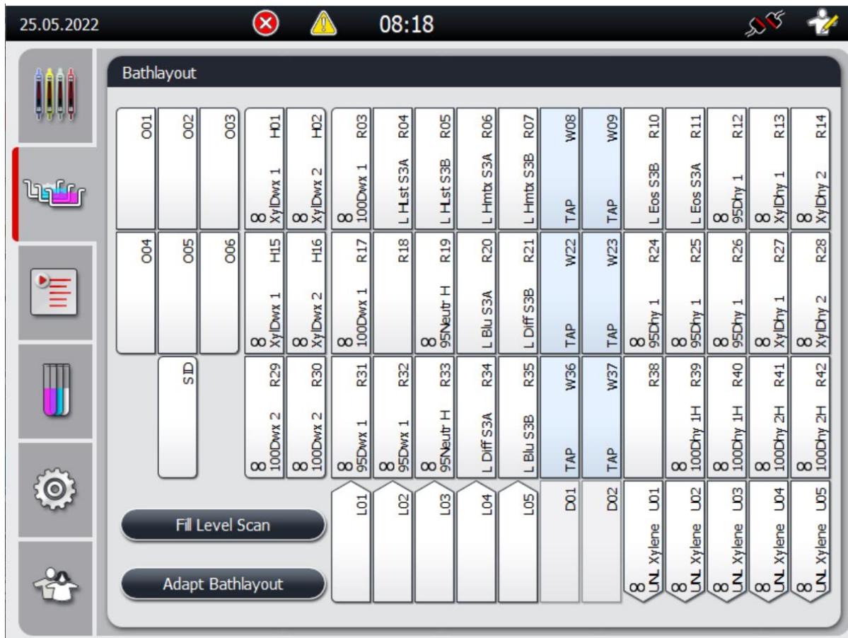
Imagem 1 – Exemplo de configuração de imersão de sistema de coloração dupla com hematoxilina e eosina
