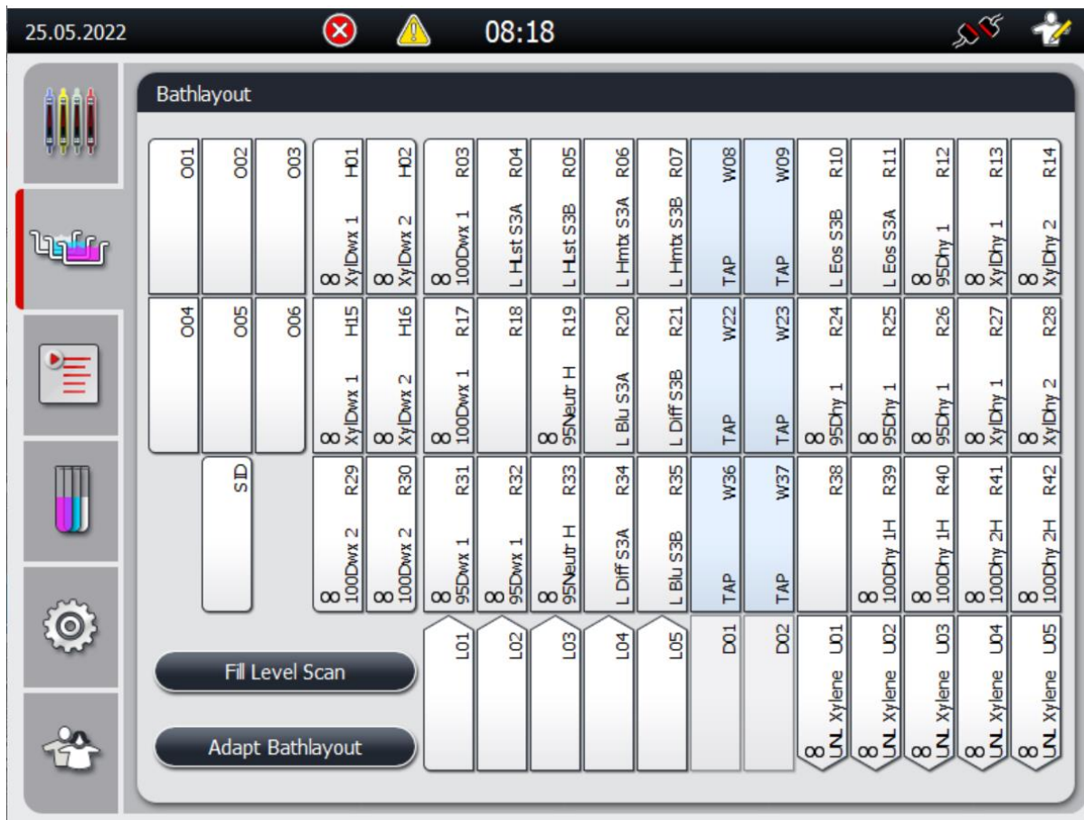
画像 1 –デュアル H&E 染色システムの Bathlayout (槽レイアウト) の例
